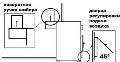
3. - откройте заслонку в дымоотводящем патрубке полностью для обеспечения максимальной тяги (если шибер шторный – то выдвинуть его полностью);
